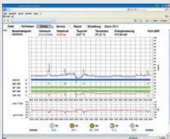
Todos los datos se calculan y representan en gráficos de alta definición (1x/seg.) – para una evaluación precisa de toda la estación de aire comprimido.
